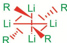
شکل ۵-۱- ساختار مکعبی پیچیده ترکیبات هیدروکربنی لیتیم‌دار
